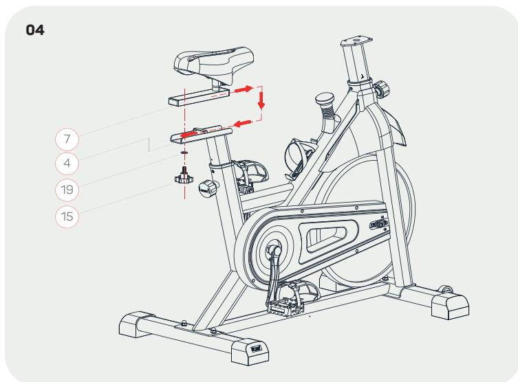
Instal·larem el marc d'ajust del selló (7) en l'estructura del selló (4) i el fixarem amb una volandera plana (19) i una rosca d'ajust (15). Recorda que has d'afluixar la rosca d'ajust (15) per a moure el bastidor d'ajust del seient (7) cap endavant i cap enrere segons sigui necessari. No oblidis estrènyer la rosca d'ajust (15) abans d'usar-ho.
