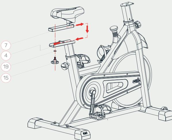
Instalaremos el marco de ajuste del sillín (7) en la estructura del sillín (4), y lo fijaremos con una arandela plana (19) y una tuerca de ajuste (15). Recuerda que debes aflojar la tuerca de ajuste (15) para mover el bastidor de ajuste del asiento (7) hacia adelante y hacia atrás según sea necesario. No olvides apretar la tuerca de ajuste (15) antes de usarlo.
