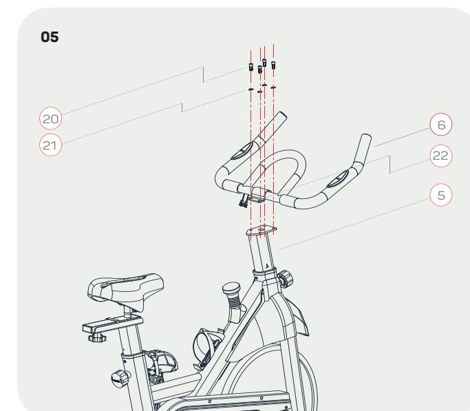
Im nächsten Schritt wird der Griffrahmen (6) mit Unterlegscheiben (17), Federringen (21) und Zylinderschrauben (20) an der Griffstange (5) befestigt. Sichern Sie diese mit einem Inbusschlüssel (27).
