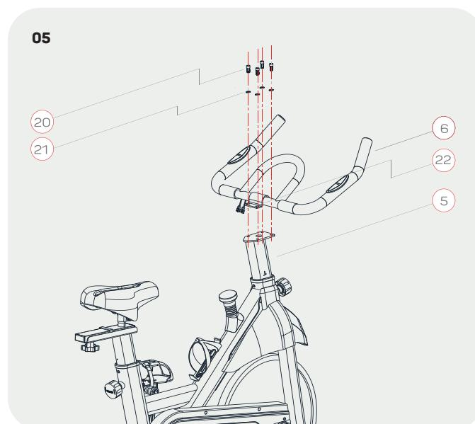
Il passo successivo consiste nel fissare il telaio della maniglia (6) al montante della maniglia (5) utilizzando rondelle piatte (17), rondelle elastiche (21) e viti a testa cilindrica (20). Fissare con una chiave a brugola (27).
