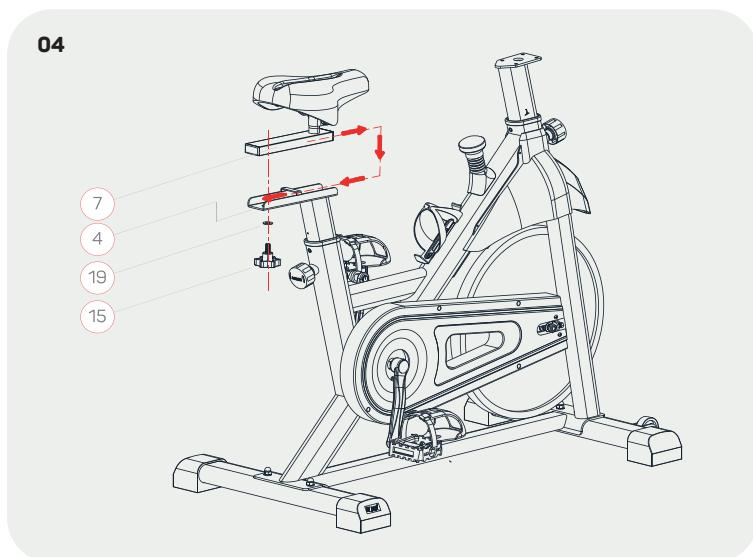
Installare il telaio di regolazione della sella (7) sul telaio della sella (4) e fissarlo con una rondella piatta (19) e un dado di regolazione (15). Ricordarsi di allentare il dado di regolazione (15) per spostare il telaio di regolazione della sella (7) in avanti e indietro secondo le necessità. Non dimenticare di serrare il dado di regolazione (15) prima dell'uso.
