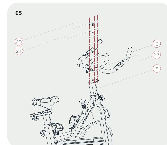
L'étape suivante consiste à fixer le cadre de la poignée (6) au montant de la poignée (5) à l'aide de rondelles plates (17), de rondelles élastiques (21) et de vis à tête cylindrique (20). Fixez-les à l'aide d'une clé Allen (27).
