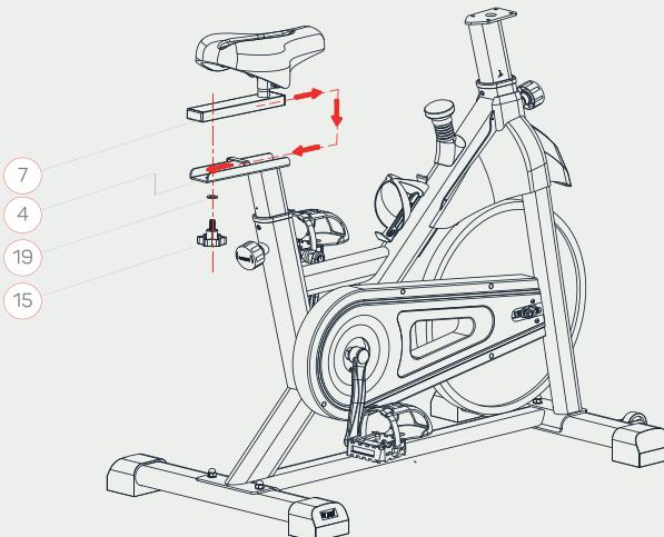
Installez le cadre de réglage de la selle (7) sur le cadre de la selle (4) et fixez-le à l'aide d'une rondelle plate (19) et d'un écrou de réglage (15). N'oubliez pas de desserrer l'écrou de réglage (15) pour déplacer le cadre de réglage de la selle (7) vers l'avant et vers l'arrière si nécessaire. N'oubliez pas de resserrer l'écrou de réglage (15) avant utilisation.
