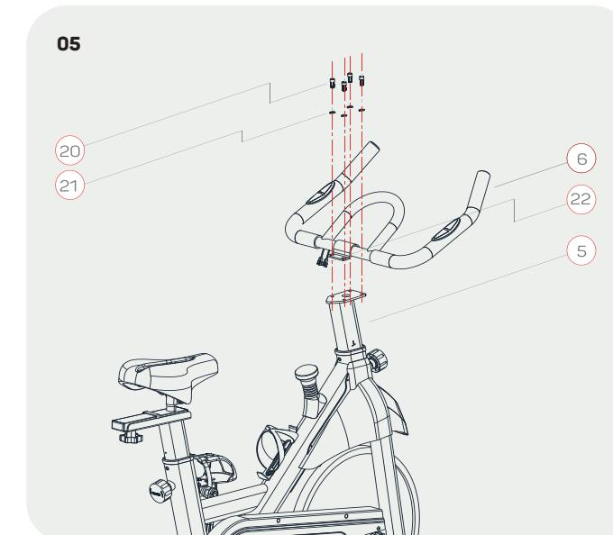
El siguiente paso es fijar el marco de la empuñadura (6) al poste de la empuñadura (5) usando arandelas planas (17), arandelas elásticas (21) y tornillos de cabeza cilíndrica (20). Asegúralo con una llave hexagonal interior (27).
