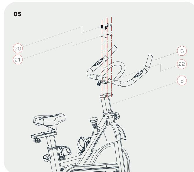
El siguiente paso es fijar el marco de la empuñadura (6) al poste de la empuñadura (5) usando arandelas planas (17), arandelas elásticas (21) y tornillos de cabeza cilíndrica (20). Asegúralo con una llave hexagonal interior (27).
