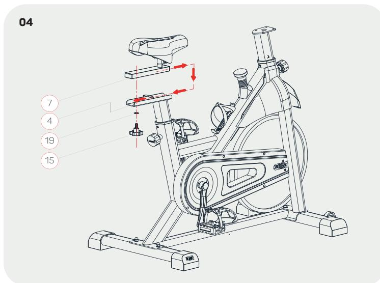
Instale a estrutura de ajuste do selim (7) na estrutura do selim (4) e fixe-a com uma anilha plana (19) e uma porca de ajuste (15). Não se esqueça de desapertar a porca de regulação (15) para deslocar a estrutura de regulação do selim (7) para a frente e para trás, conforme necessário. Não se esqueça de apertar a porca de regulação (15) antes de a utilizar.
