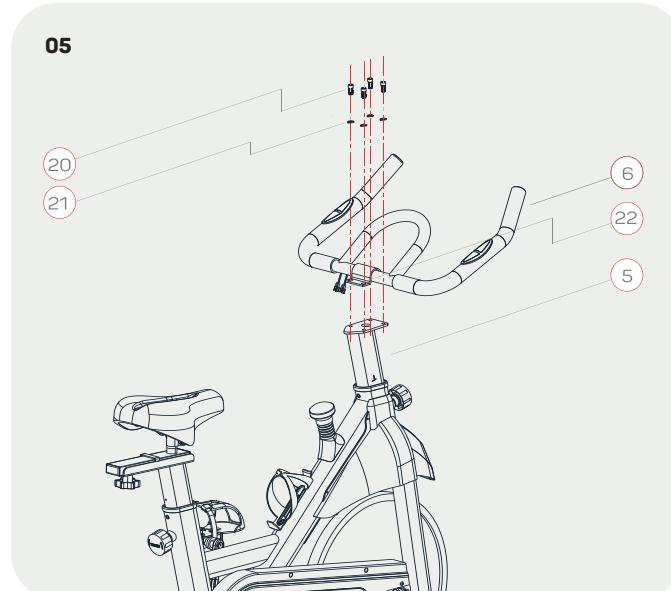
El següent pas és fixar el marc de l'empunyadura (6) al pal de l'empunyadura (5) usant volanderes planes (17), volanderes elàstiques (21) i caragols de cap cilíndric (20). Assegura-ho amb una clau hexagonal interior (27).
